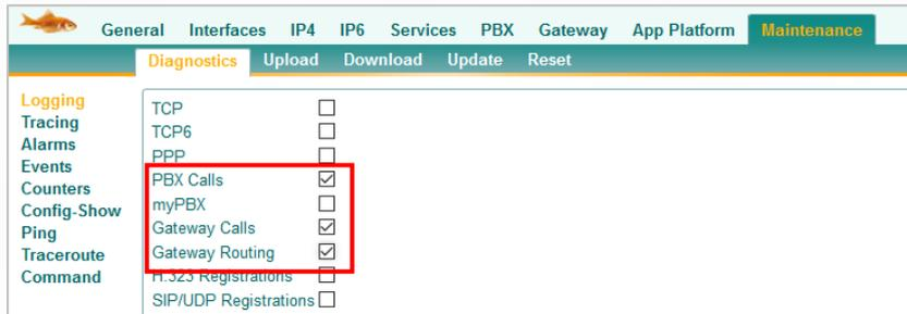
Dans le logging lui-même, il est recommandé de chercher les entrées avec "INTERFACE MAP". On y voit comment les numéros d'appel sont manipulés sur les interfaces et quelles interfaces sont utilisées. On peut généralement en déduire les itinéraires.
